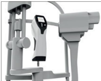
Figura 11. Estesiómetro colocado na lâmpada de fenda
