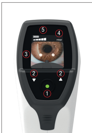
Figura 2. Parte posterior del dispositivo 1: Botón de descarga. 2: Flechas de arriba/abajo para selección de nivel. 3: Pantalla. 4: Visualización de la presión. 5: Visualización del nivel de estímulo.
